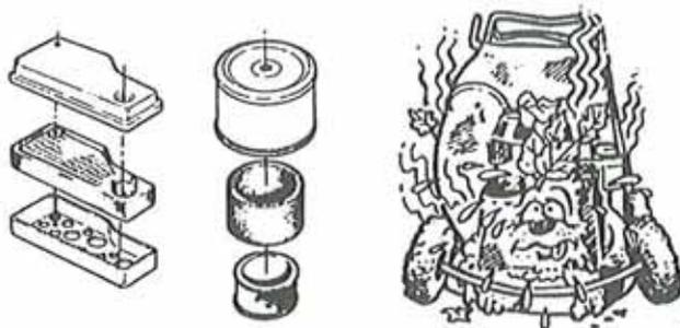
一般的にウレタンフォームのフィルターは食器用洗剤で洗って、よくすすぎ乾燥します。その後エンジンオイルを少し染み込ませてから、軽く絞って余分なオイルを絞り出します。
