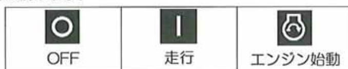
8. エンジンが始動したら、キーから指を離して、スロットルレバーを徐々に戻し、エンジンがスムーズに回転するまでしばらく暖機運転します。
