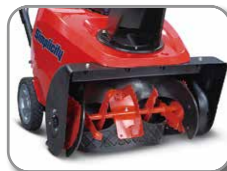
パワフルなシングルステージ構造 および金属補強入りゴムオーガ
