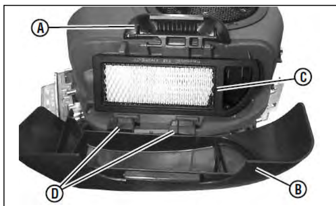
図 7-5 エアクリーナカバーを外す (エンジンモデルによっては異なることもあります)
