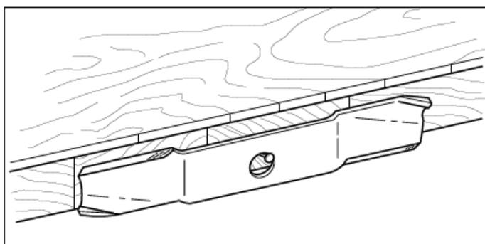
図 20 ブレードのバランスの確認
