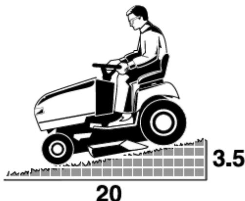
急な斜面で機械を使用した場合、重大な事故や死亡事故を引き起こす可能性があります。急すぎる斜面や補助装置などがない状況で使用すると、コントロールを失ったり、横転する可能性があります。補助装置がない状態では決して傾斜地で操作しない事が一番です。6mで1m以上上昇する傾斜では、決して操作しないで下さい。
