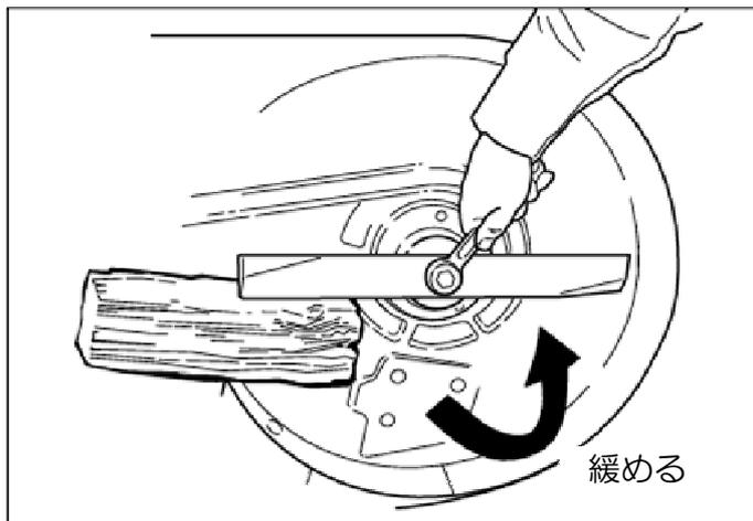
図 19 ブレードの取り外し
