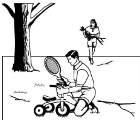
この機械には、回転刃がついています。障害物があるとブレードが、障害物を吸い上げ吹き飛ばし、重大な事故を引き起こす可能性があります。芝刈を行なう前に、作業場から障害物を取り除いて下さい。芝刈機を使用する際は、集草装置を付けるか、サイドシュートを取り付けてください。
