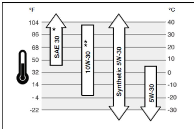
\* 外気温 4°C以下で SAE 30 のオイルを使用すると始動不良となります。
