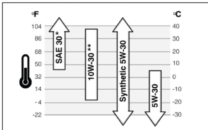
\* 外気温 4°C以下で SAE 30 のオイルを使用すると始動不良となります。
